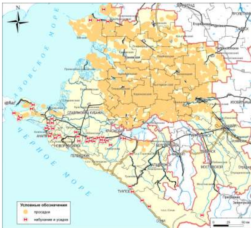
Рисунок 1.2 – Просадочные явления в пределах территории Краснодарского края (по материалам ГУП «Кубанская краевая научно-производственная компания минеральных ресурсов и геоэкологии «Кубаньгеология», Краснодар, 2007)
